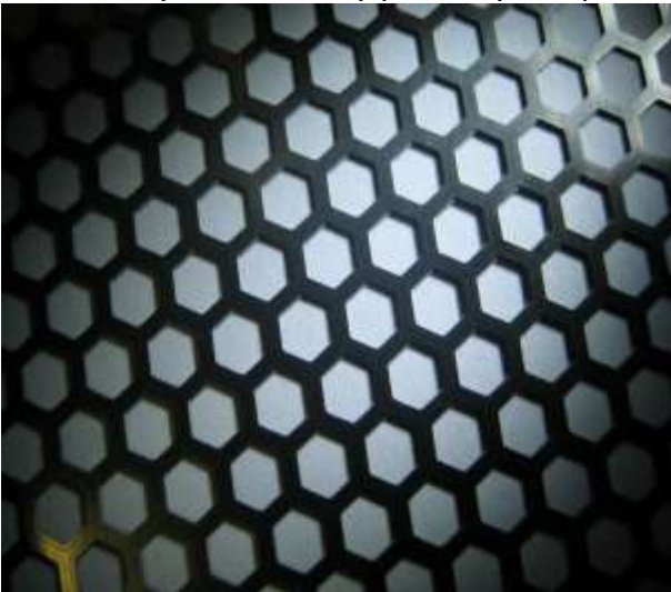
Nerezový kolimátorový plech síly 250 μm
